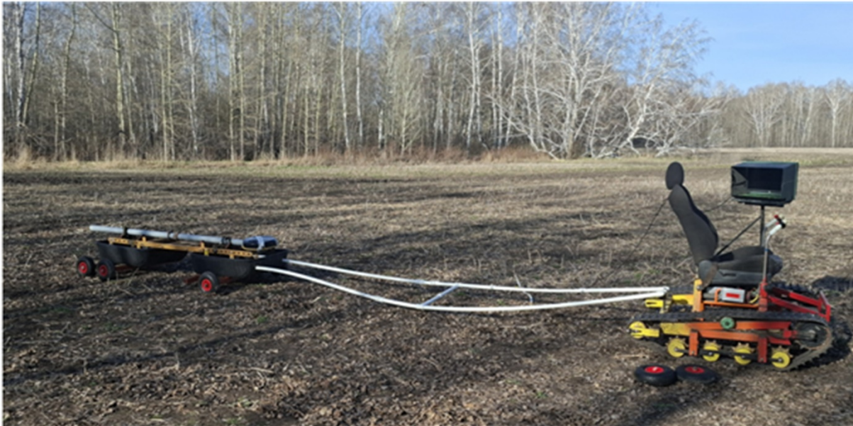
Рисунок 1. Аппаратура ЭМС, буксируемая гусеничным транспортером
