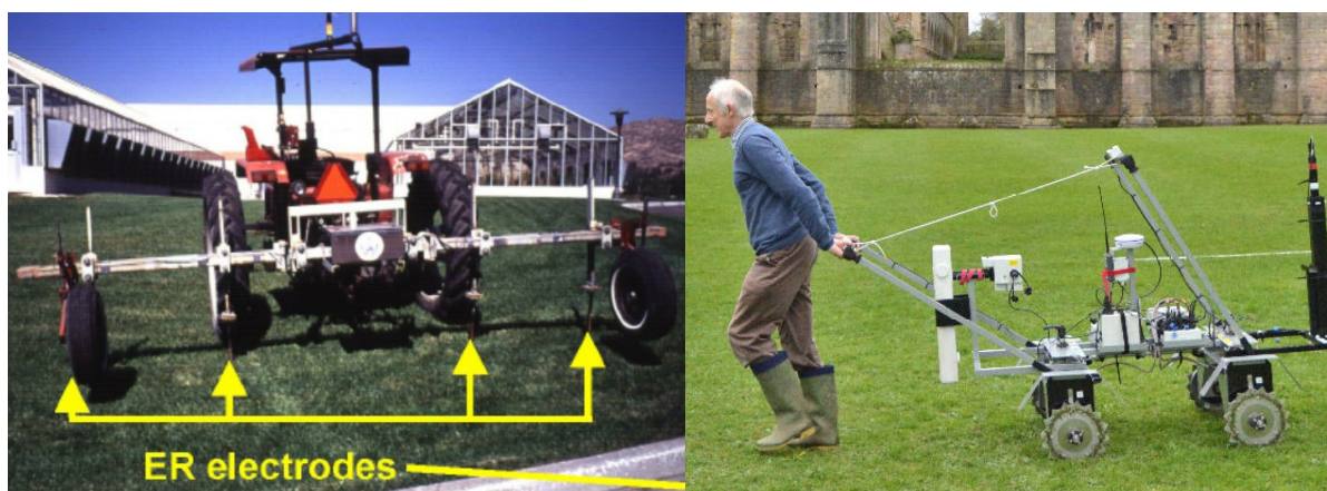
Рисунок 2. Устройства для автоматического электропрофилирования: монтаж на трактор для исследования пашни (слева, J. D. Rhoades, США) и сборка в виде телеги, колеса которой служат заземлителями (справа, Geoscan Research, Англия)
