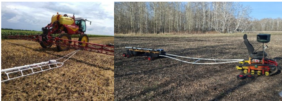
Рисунок 6. Российская аппаратура для многочастотного электромагнитного профилирования АЭМП-14 в ходе исследований сельскохозяйственных полей в Ростовской и Новосибирской областях, при буксировке сельхозмашиной и гусеничным транспортером
