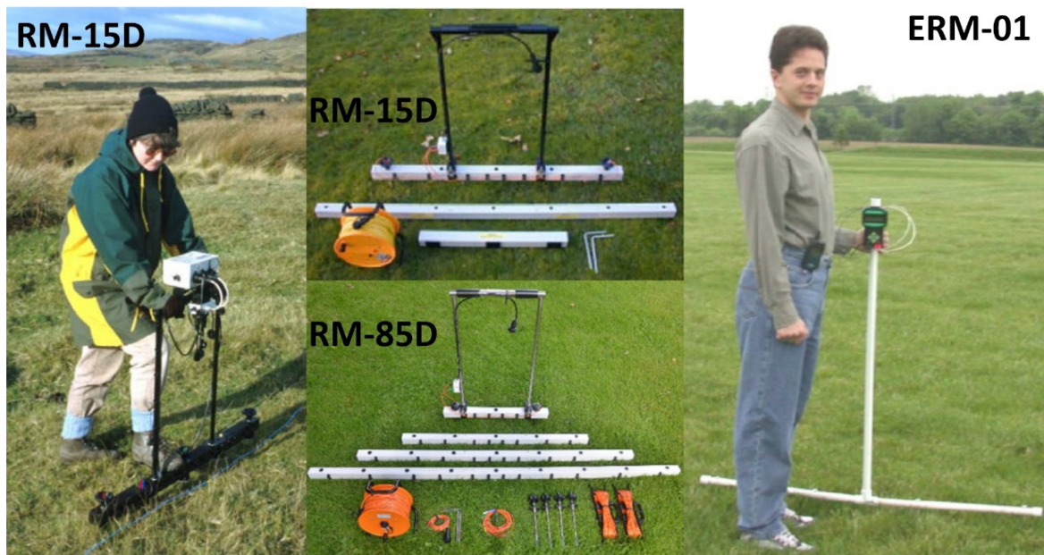
Рисунок 1. Устройства для электропрофилирования: RM (слева, Geoscan Research, Англия) и ERM-01 (справа, Landviser, США)
