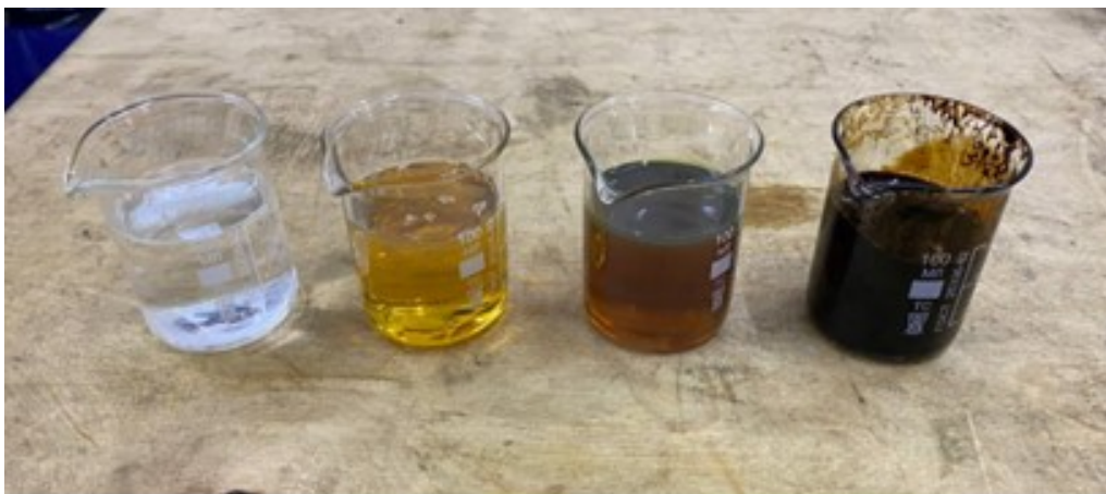
Рисунок 5. Пробы модельных жидкостей: вода техническая, масло гидравлическое (кинематическая вязкость 16 сСт), масло гидравлическое (кинематическая вязкость 220 сСт), нефть сырая без газа
