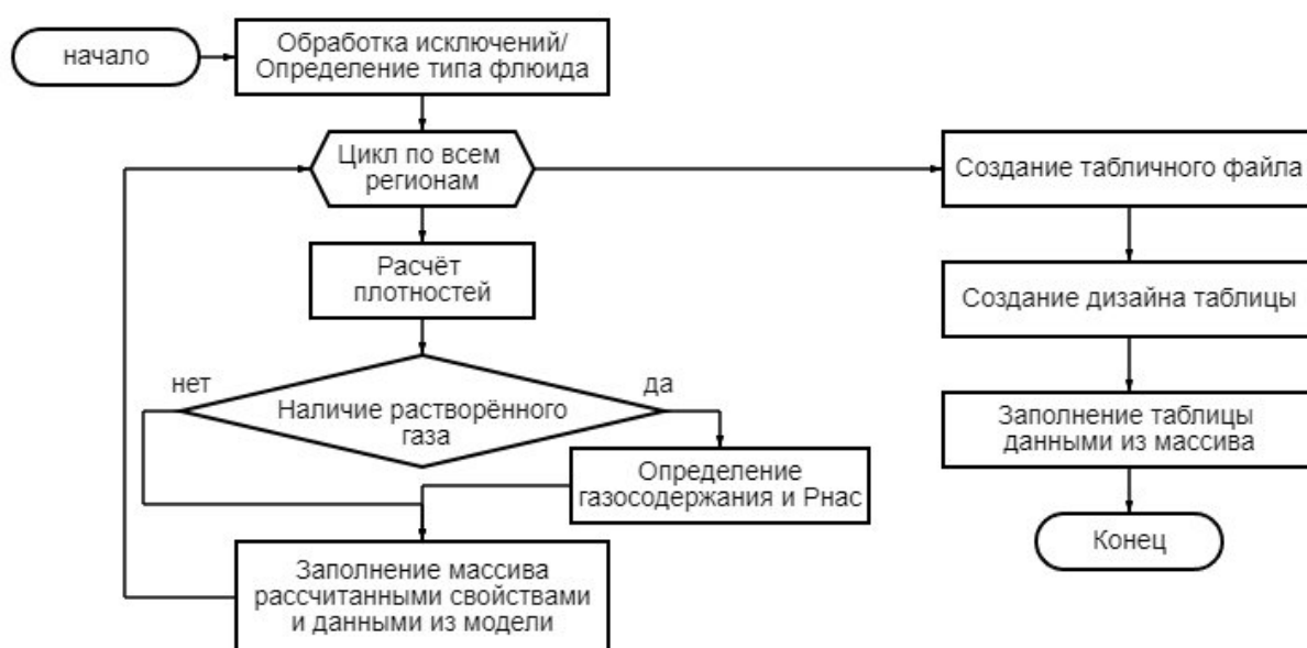
Рисунок 1. Блок-схема № 1 Python-сценария по выгрузке свойств флюида
