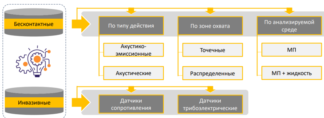
Рисунок 1. Классификация датчиков регистрации механических примесей
