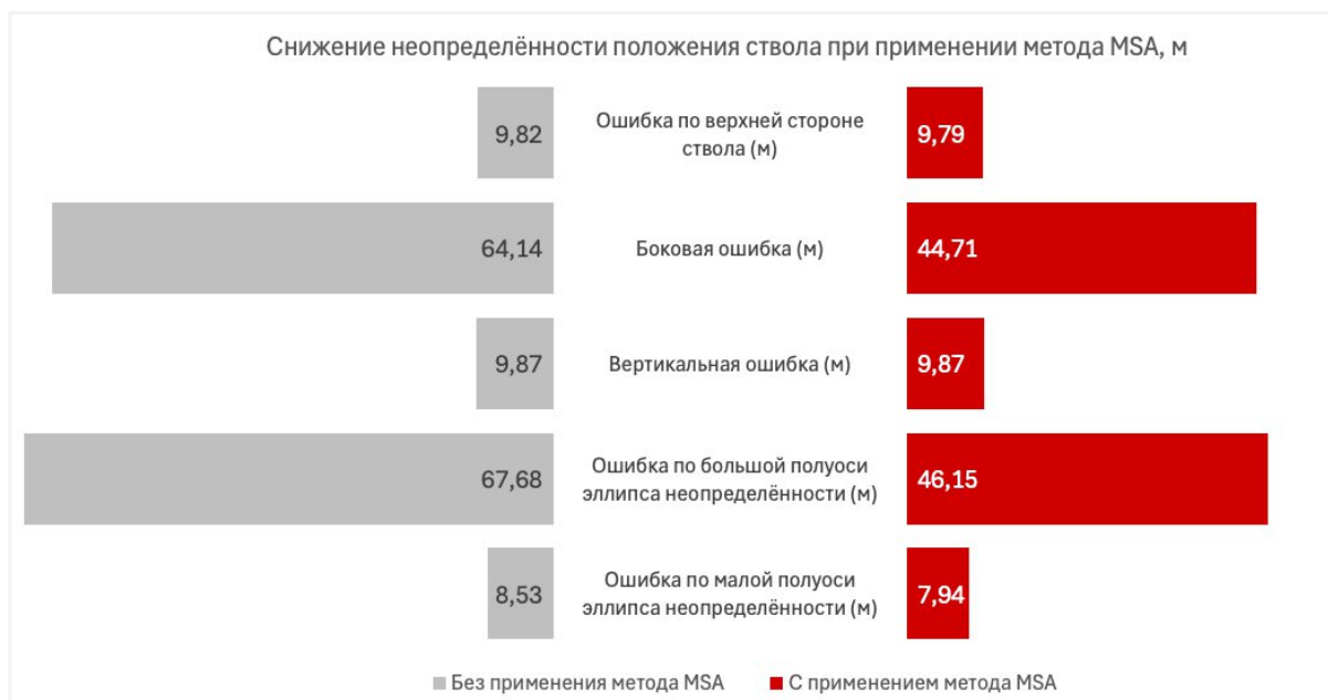
Рисунок 9. Снижение неопределенности положения ствола скважины при применении MSA
