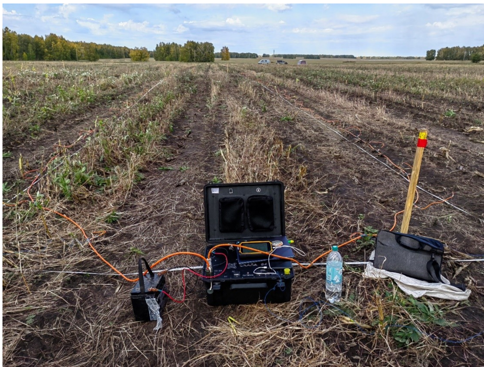
Рисунок 1. Измерительная установка в полевых условиях на курганном могильнике Конево-10. Аппаратура Скала 64K15E.
